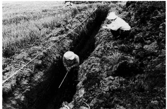
試掘坑断面土層図の作成
