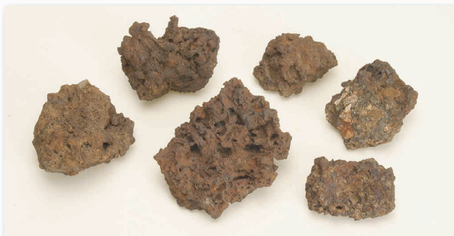
鉄滓 (てつさい) : 鉄を作る際に燃料や不純物などが溶融した鉄かす
