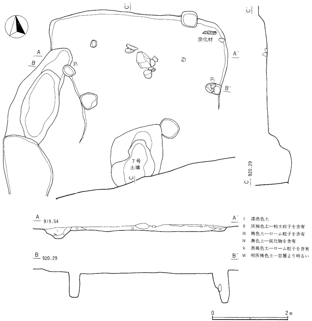
が検出された。P<sub>1</sub>・P<sub>2</sub>はその位置関係から棟持ち柱に関わる柱穴と考えられ、竪穴が上部構造をもっていたことが窺える。棟持ち柱用の柱穴しか検出されなかった点などを考えると、本址の上部構造は簡単なものであった可能性が高い。
