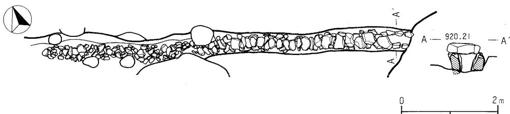
第20図 第1号暗渠址（平面図1/80・断面図1/40）
