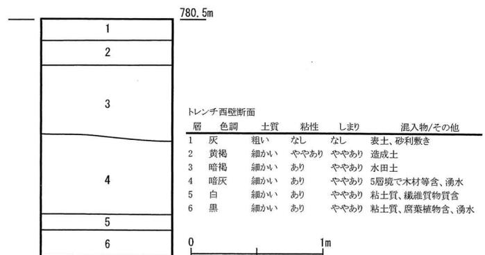
第 14 図 トレンチ西壁断面図 (S=1/40)
