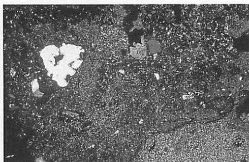
図4 第一次大極殿SB7200地覆石 （流紋岩質溶結凝灰岩） 偏光顕微鏡写真 約12.5倍 左：-ニコル 右：+ニコル
