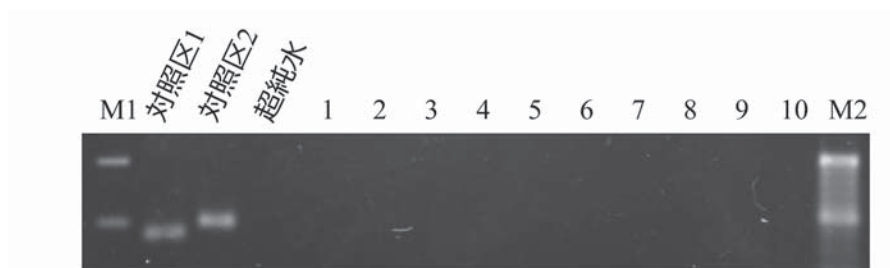
図104 宇木汲田遺跡 no.30 (HUA145) の出土米における Rc 遺伝子に特異的プライマーでPCR増幅した産物の電気泳動図。M1: 100bp DNA ladder、対照区1: 褐色種皮のイネ‘日本晴’、対照区2: 赤色種皮のイネ“T0221”、1-10: 出土米 DNA、M2: 20bp DNA ladder。
