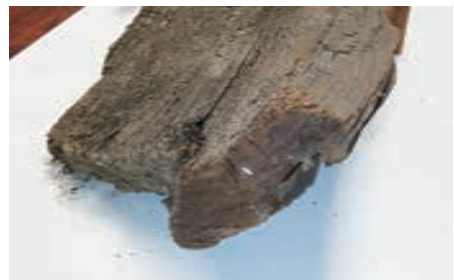
5 鋸による切断面
