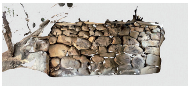
図7 iPadによるLiDAR計測した関西学院構内古墳の墳丘と石室。初めて操作する学生が計測。墳丘は20分程度、石室は10分程度の作業
