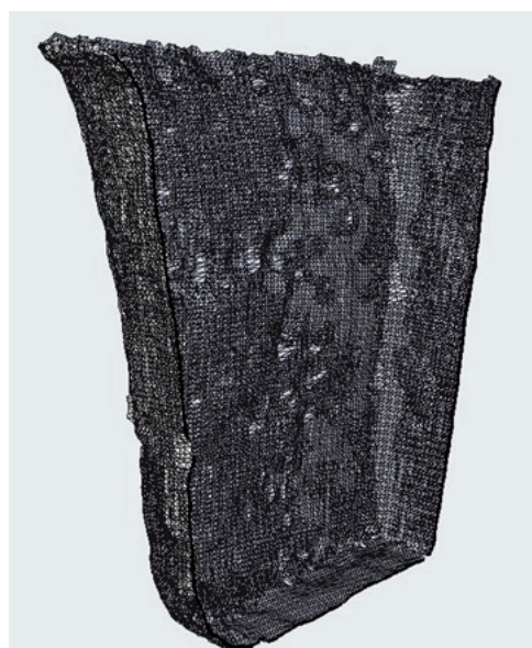
図3 型取りしたシリコンを3次元スキャナーNextEngineで3D化
