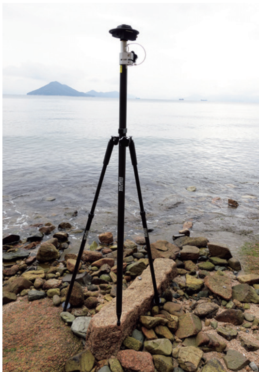
図6 RTK-GNSS測量の様子
