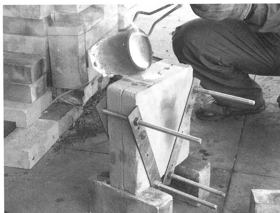
図版 38 鈴鏡縦置き鋳型に湯入れ
