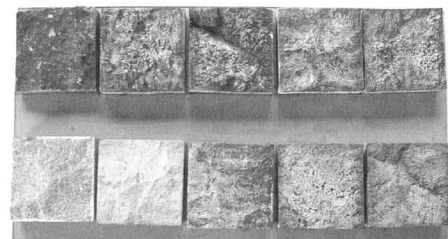
酸化鉄実験模型1/溶剤混合比…第二酸化鉄:松煙:水
