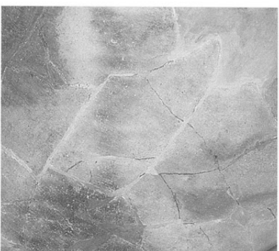
写真22 筋状酸化（篠ノ井50-1の外B面）
