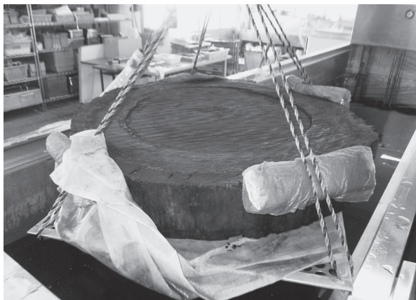
写真5 PEG 含浸槽からの取り出し作業
