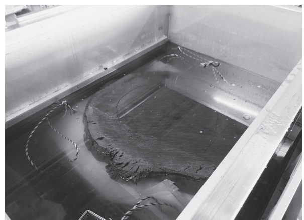
写真4 安定化処理（PEG 含浸作業中）
