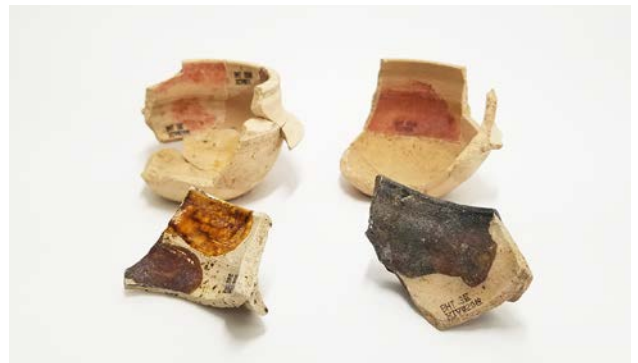
第9図 豆羽釜の破片を再利用したテストピース（鉄釉）
