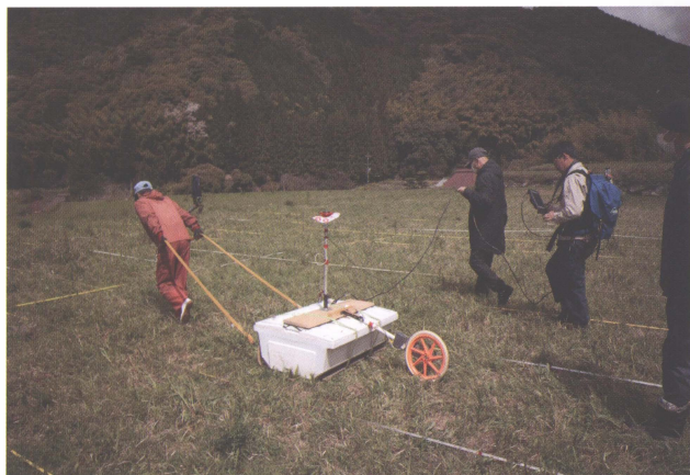
地中レーダー探査風景
