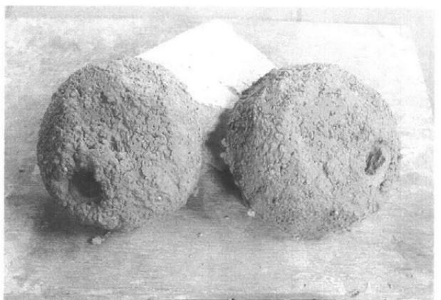
写真5 湯口を残して荒真土で周囲を固定
