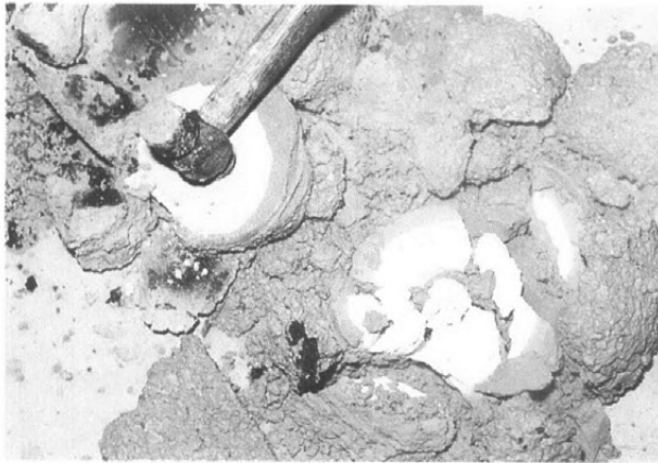
写真7 冷えたら鑄型を壊し、釧を取り出す
