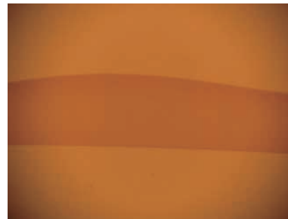
第6図 生漆・クロメ漆の漆膜断面(×50) 左:試料No.1(生漆) 右:試料2(クロメ漆)
