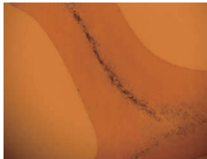
第6図 生漆・クロメ漆の漆膜断面(×50) 左:試料No.1(生漆) 右:試料2(クロメ漆)
