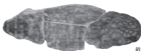
第 11 図 クヌギ節の放射状組織(柁目板)
