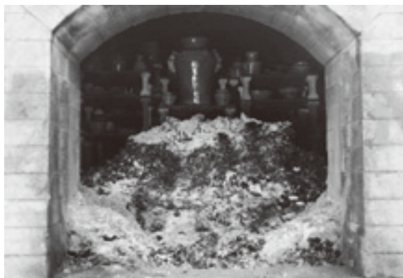
写真5 窯出し直前のオキの蓄積状況
