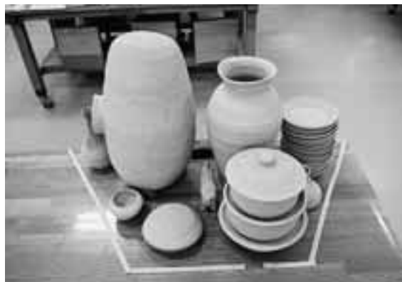
写真3 窯内製作品配置計画（焼成部最奥段）
