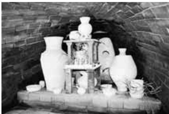
写真4 窯詰め状況（焼成部奥より2段目）
