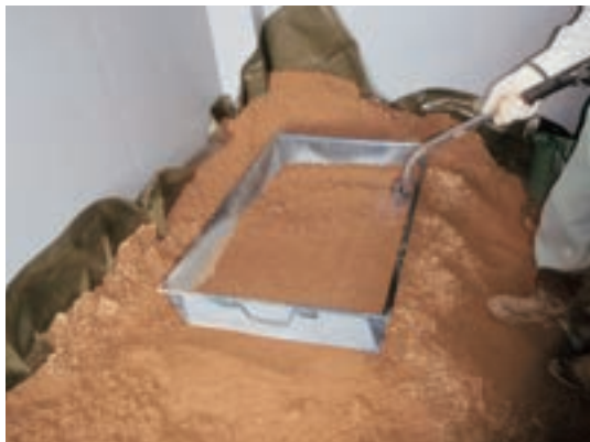
Fig.31 購入土のバーナーによる滅菌作業
