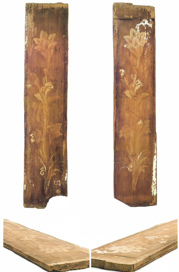
図 14 樹皮が残存し伐採年が特定された東塔初重支輪裏板
