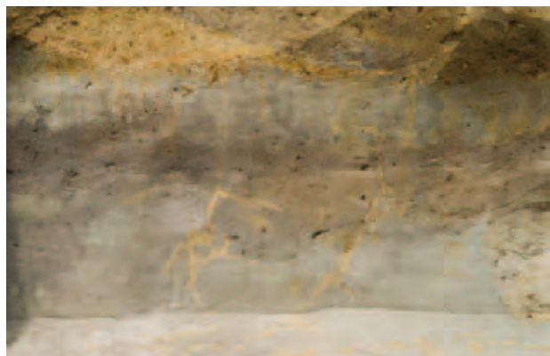
調査区西壁の液状化の痕跡（砂脈と噴砂丘）
