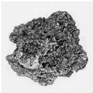
図5 直径 1 cm の気孔の多いスコリア例。 無酸素状態で固化した芯部は黒色気孔であり、表層部の気孔は高温で酸化したため赤鉄鉱ができて赤褐色を呈する。気孔面積比は 50% を超えている。
