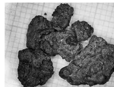
図11 第7層上半を構成する固結破碎円礫入りスコリア層。方眼は 1mm 間隔。
