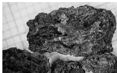
図6 高温酸化した柏原遺跡大淵スコリア 気孔面積比は 50% を超える。破断面には円柱状気孔が見える。その気孔間壁隔膜に小球状小気孔が見える。グラフ用紙の方眼間隔は 1 mm である。
