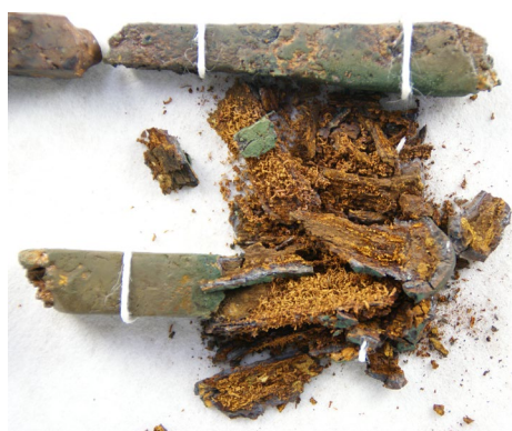
図3 鉄製遺物の劣化を引き起こすさび 図4 展示環境のモニタリングの様子
