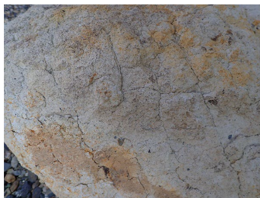
図2 乾湿繰り返しによる石材の割れ
