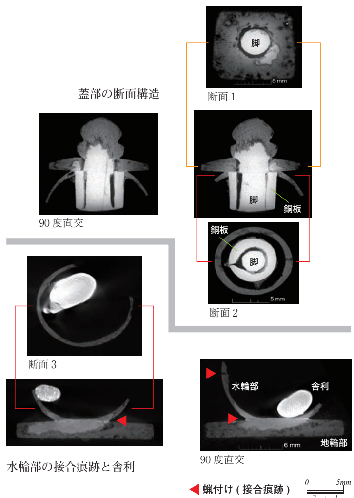
写真1 金銅製舍利容器X線CT画像
