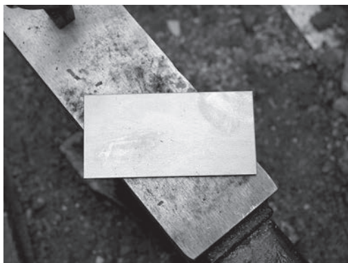
5 実験に使用した鉄板 (100mm×50mm)
