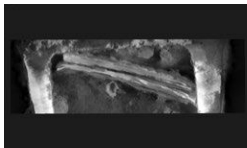
第124図 鑄造鉄斧袋部内部のCT画像
