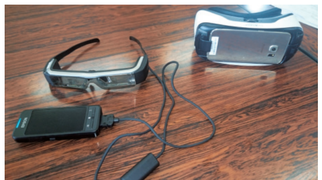
図39 スマートグラス(左)とヘッドマウントディスプレイ(右)
