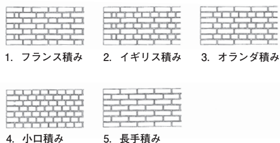
図2 れんがの積み方 (横浜開港資料館『日本の赤煉瓦 1851-1923』より)
