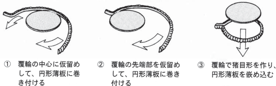
第25図 覆輪の中央に薄板を詰め込む技法3種（依田 2001 より引用）
