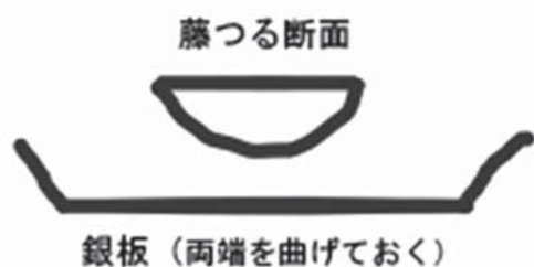
第8図 銀板の両端を曲げておく
