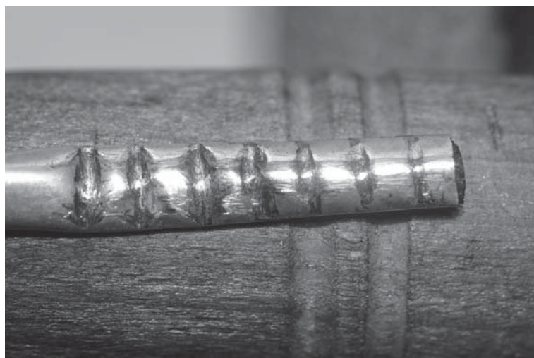
第10図 彫刻した藤つる下地に銀板を巻きつけ、千枚通しとへらで押えて粒を成形
