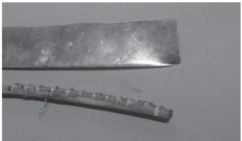
第7図 厚さ0.1mmに鍛造した純銀板（99.99%）と断面半円形に加工した藤つる
