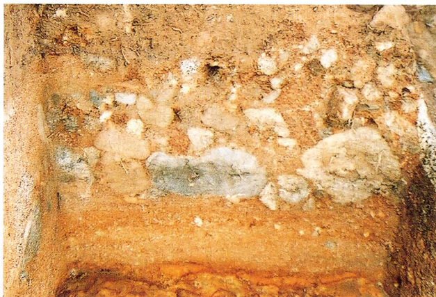
Fig.35 領家式花崗岩類の基盤を不整合に覆う礫層
