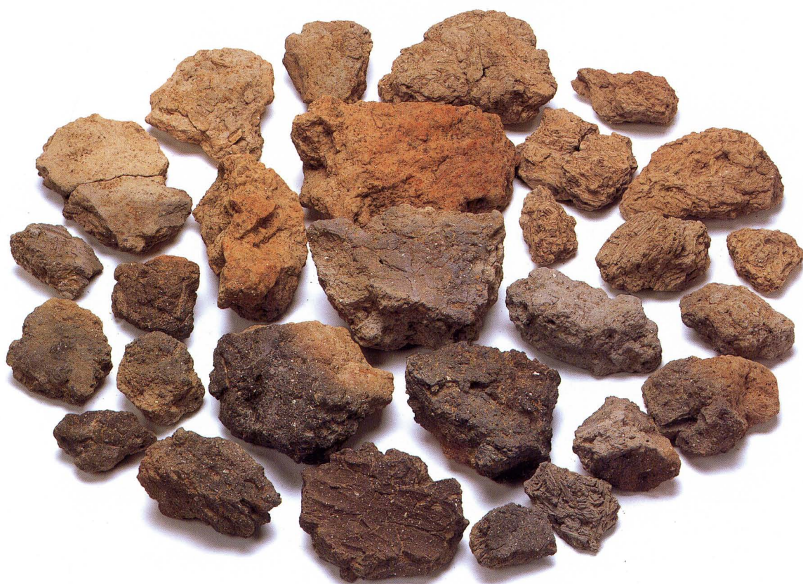
上：鉄釜鑄型片 下：溶解炉壁片
