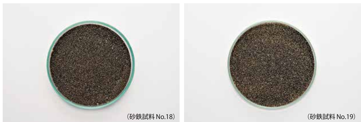
第113図 朝日たたら跡の砂鉄試料 No.18 (左)・No.19 (右)
