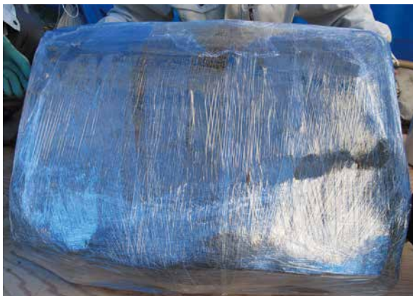
1. 取出し壁面のラッシング状況
