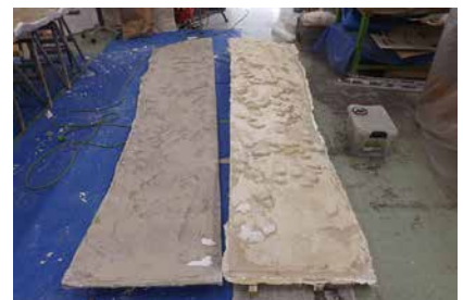
5. 【工程9-(3)】右：脱型、左：型成形成品
