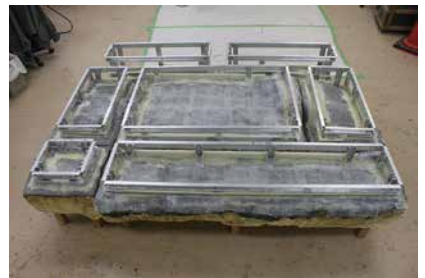
9. 工程 11 各壁面の仮合わせ作業
