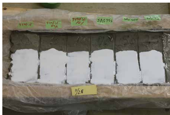
2-2. 粘土層へのシリコン樹脂塗布試験
