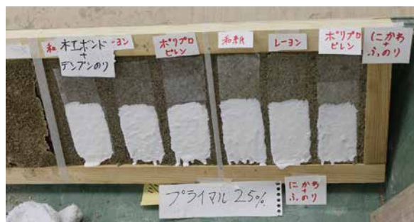
2-1. 砂層へのシリコン樹脂塗布試験
