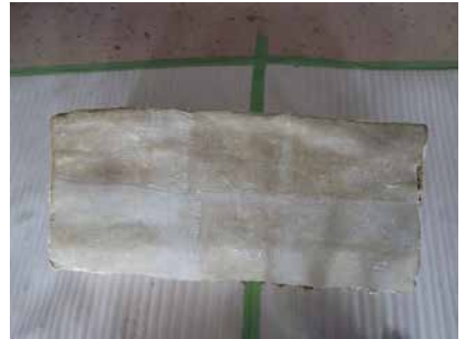
6. 工程 11 背面へのガラスマット貼り込み状況
