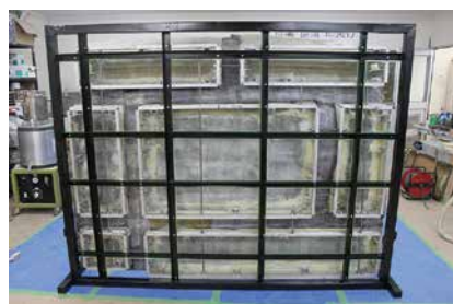
2. 工程 14 仮固定台の設置状況 (背面から)
