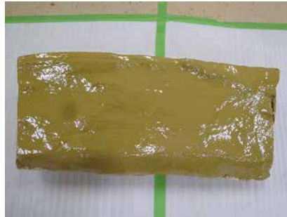
5. 工程 11 背面へのエポキシ樹脂塗布状況
