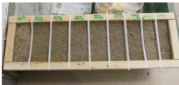
2-3. 砂層へのポリウレタン樹脂塗布試験
