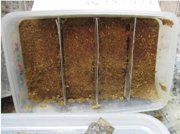
1. 採取した土壌に対する固化試験（水平方向への薬剤塗布）
