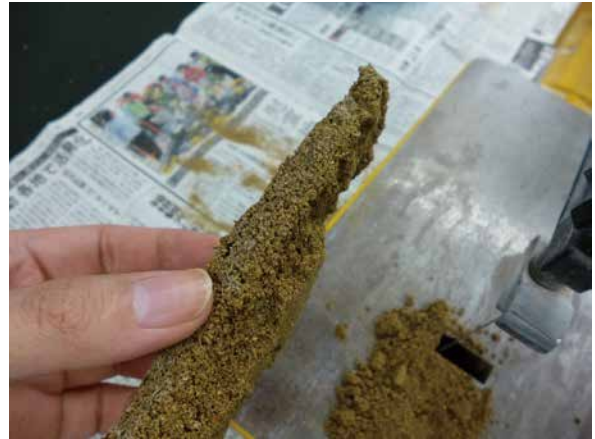
2. 採取した土壌に対する固化試験（固化状況確認）
