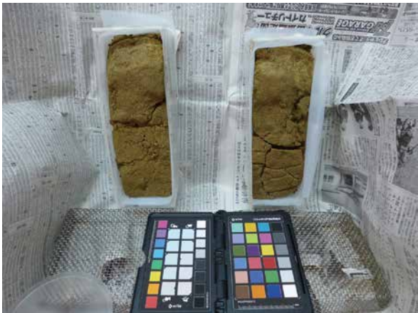
3. 採取したブロック状土壌に対する固化試験
