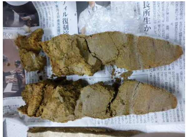
4. 採取したブロック状土壌に対する固化試験（固化状況確認）
