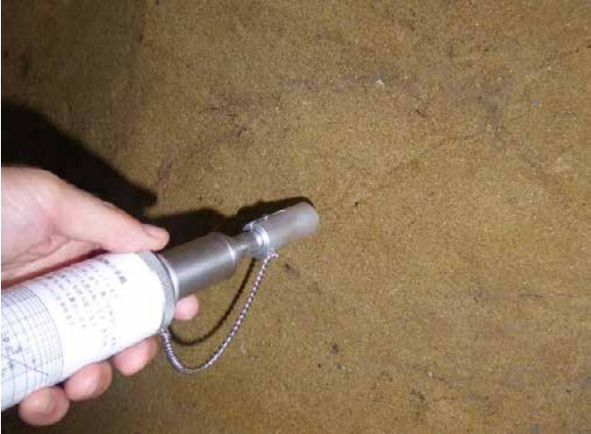
第 32 図 軟岩ペネトロ計による強度計測
