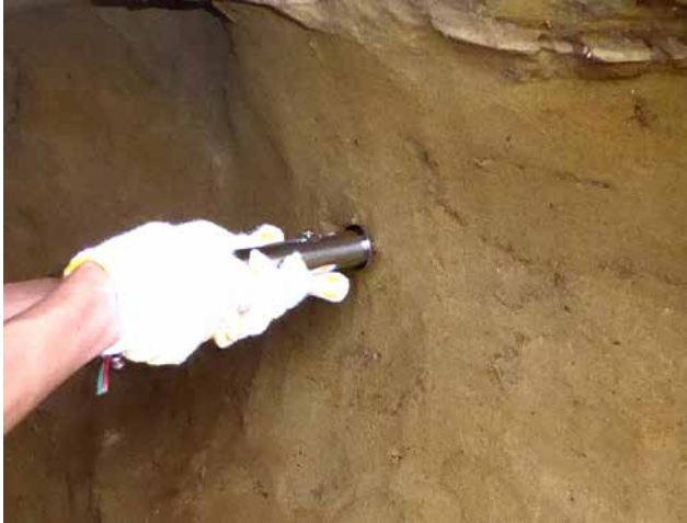
第 33 図 山中式土壌硬度計による硬度計測
