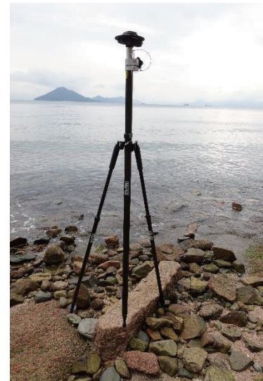
図 14 海岸の石材を RTK-GNSS で位置測定
