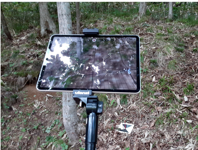
図 4.3 Metascan による LiDAR 計測 (画面下にターゲットマーカが見える)
