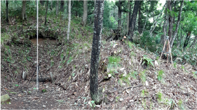
図 4.2 オートレベルによるターゲットマーカの水準計測
