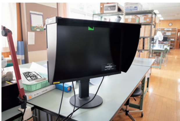
図10 キャリブレーション中のカラーマネジメントモニター
