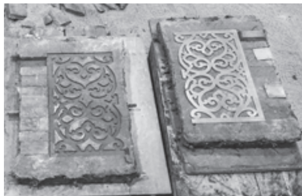
図10 金型の原型を用いて製作した真土型
