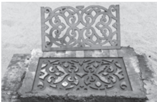
図9 朴原型を用いて製作した真土型
