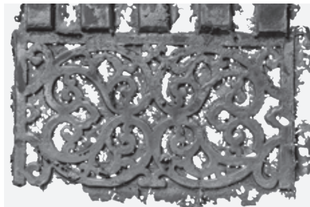
図12 金型の原型による真土型で鑄造した地金
