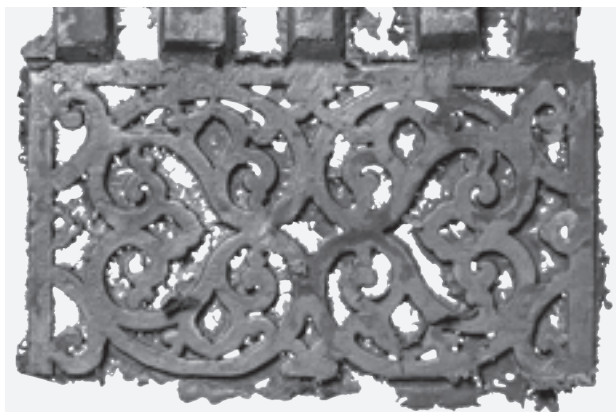
図11 朴原型による真土型で鑄造した地金
