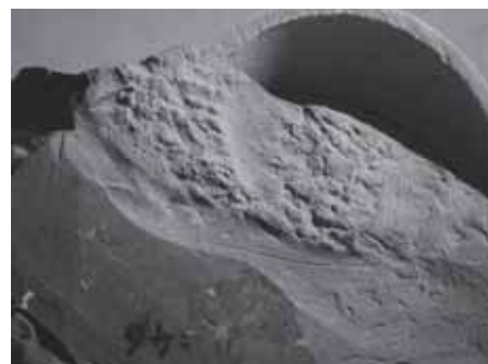
瓦の破断面に見える成形時の胎土の状態 (1・2 鄴城朱明門遺跡出土の瓦)
