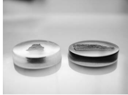
写真2 研磨中の試料 観察に適した細胞組織が現れた面で止める
