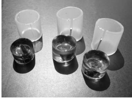
写真1 エポキシ樹脂に包埋した試料 ポリエチレンチューブの中で固化させる
