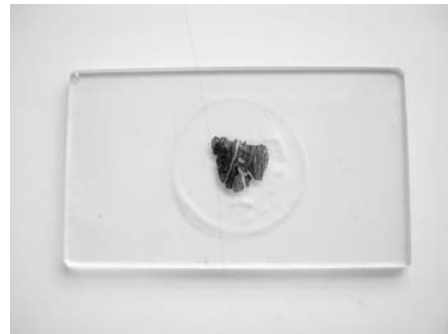
写真4 完成したプレパラート スライドガラスに接着した試料を透過光で 観察できる厚さまで研磨する
