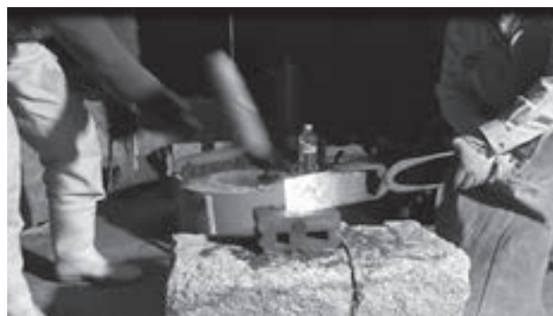
図19 鉄矢の鍛造加工
