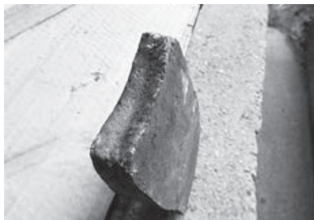
図20 復元した鉄矢の先端形状
