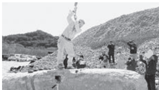
図22 玄能で鉄矢を叩く矢締め（石割工程）
