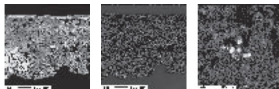
図43 下地漆喰のBSE画像(左)および鉛分布測定図(中央・右)
