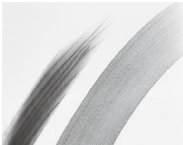
図2 左=鉋、右=台鉋によるこけら板成果物
