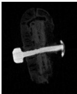
図44 目釘部分のX線CT画像
