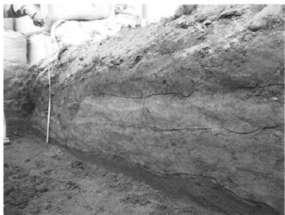
南側擁壁基礎部確認トレンチ 地山層の上部が攪乱されている
