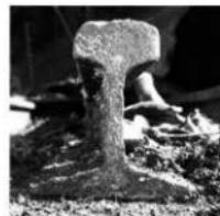
第20図 横穴壕掘削に使用されたトロッコのレール
